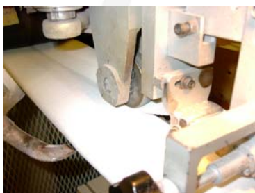
Filterposen svejses i den langsgående søm
